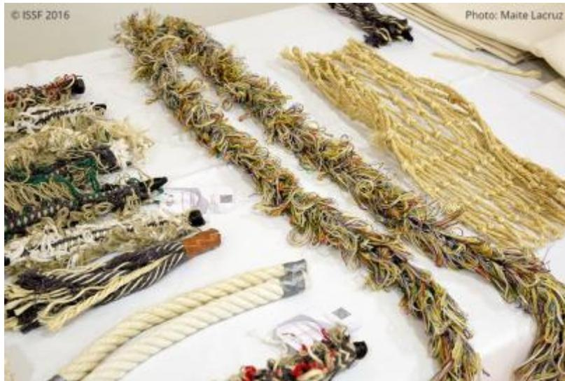
Fig. 1. Tipos de cuerdas biodegradables de origen natural analizadas durante el taller.
